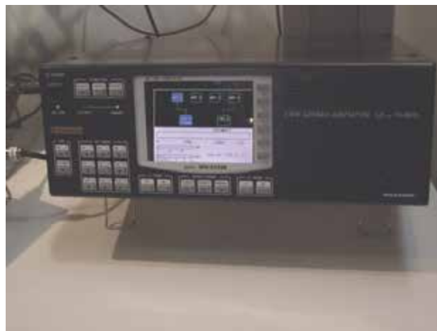
Bild 1: 1-kW-Endstufe von Hilberling
